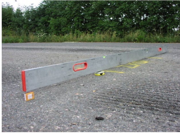
Podélná nerovnost je větší než dovolených 2 % a tedy více než 2 cm/1 m
