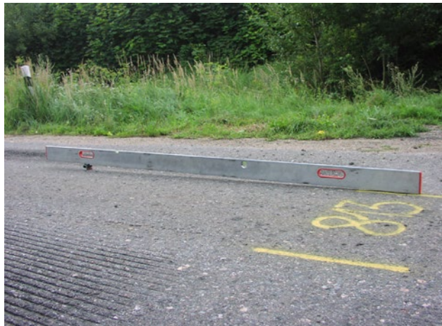
Příčná nerovnost je větší než dovolených 2 % a tedy více než 2 cm/1 m
