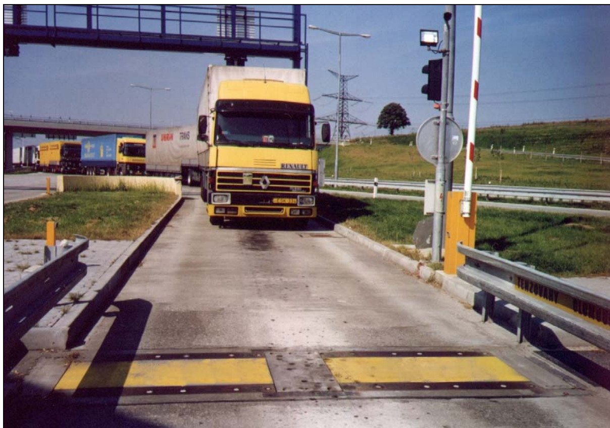
obr. 3: Kontrola okamžité hmotnosti silničních vozidel na HCP Rozvadov
